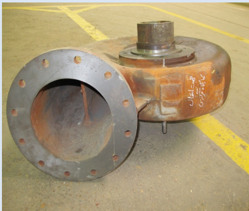
شکل ۱- نمونه پوسته پمپ ساخته شده توسط مجری پروژه
