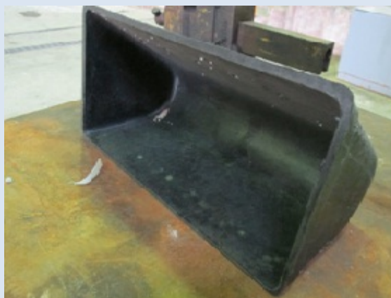
شکل ۳- نمونه باکت غیر فلزی ساخته شده
